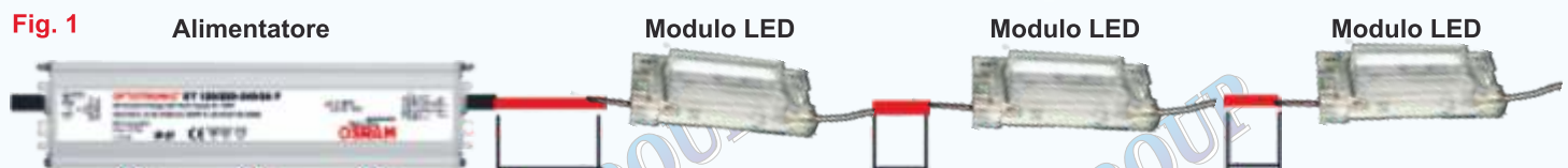
Lunghezza massima del secondario= Distanza tra alimentatore e il primo modulo della catena + estensione cavo tra i moduli LED
