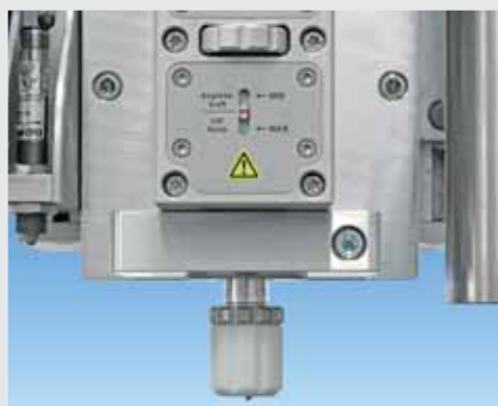
La lancia sporge leggermente dal manicotto distanziatore; con la ghiera di regolazione sopra illustrata la pressione di contatto può essere regolata.
