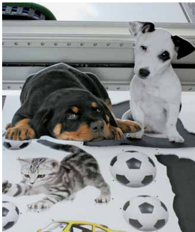
Esempio di impiego nel settore della tecnica pubblicitaria: lastra in poliuretano espanso con immagini fresate.
