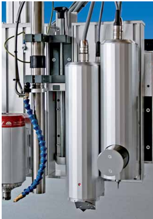
Tre unità di lavorazione in uso contemporaneamente su una macchina Active Pro: all'estrema sinistra il mandrino di fresatura, accanto la Testa Multi Funzione.
