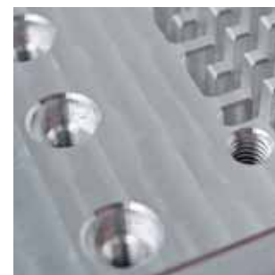
Realizzazione di filetti con o senza svasature.
