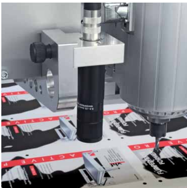
Cenon CCD riconosce i crocini di centratura stampati e li utilizza per calcolare la rotazione necessaria e la scala dei percorsi di output.
