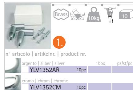
**IT** tirante snodabile per cavi, sistema in tensione **autobloccante**. montare il tirante ed inserire il cavo: il sistema di autobloccaggio lo trattiene automaticamente. regolare la tensione avvitando il tirante. **fissaggio**: tirante per cavi, sistema autobloccante in tensione, snodabile, per soffitto e parete. **materiale**: ottone color cromo e argento. **spessore del cavo**: max. Ø2mm.
