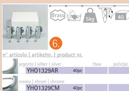
**IT pinza laterale regolabile.** per pannelli su cavi di acciaio. il fissaggio di pannello e di cavo avviene tramite le brugole. **fissaggio:** pinza laterale per cavi di acciaio, sistema a brugola. **materiale:** ottone con cromatura in color argento satinato o cromo lucido. **spessore del pannello:** max. 10mm, spessori maggiori con brugole più lunghe. **spessore del cavo:** max. Ø2mm.
