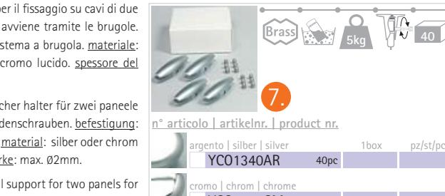
**IT pinza laterale doppia.** morsetto laterale per il fissaggio su cavi di due pannelli affiancati. il fissaggio al pannello e al cavo avviene tramite le brugole. **fissaggio:** pinza laterale doppia per cavi di acciaio, sistema a brugola. **materiale:** ottone con cromatura in color argento satinato o cromo lucido. **spessore del pannello:** max. 4mm. **spessore del cavo:** max. Ø2mm.
