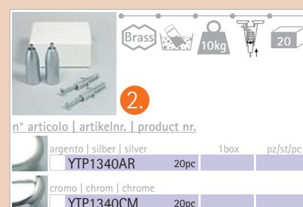
**IT** tirante per cavi, sistema in tensione **autobloccante**. montare il tirante ed inserire il cavo: il sistema di autobloccaggio lo trattiene automaticamente. regolare la tensione del cavo avitando il tirante. **fissaggio**: tirante per cavi, sistema autobloccante in tensione. **materiale**: ottone color cromo e argento. **spessore del cavo**: max. Ø2mm.
