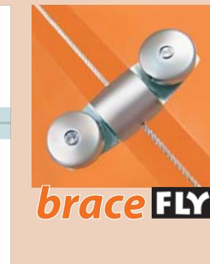
**IT pinza laterale doppia regolabile.** morsetto laterale per il fissaggio su cavi di due pannelli affiancati. il fissaggio al pannello e al cavo avviene tramite le brugole. **fissaggio:** pinza laterale doppia per cavi di acciaio, sistema a brugola. **materiale:** ottone con cromatura in color argento satinato o cromo lucido. **spessore del pannello:** max. 10mm, spessori maggiori con brugole più lunghe. **spessore del cavo:** max. Ø2mm.
